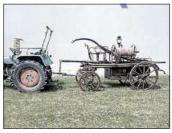
von der Konstruktionsform einer Hydrophore. Es gab die Hydrophore in verschiedenen Baugrößen, die von kleinen tragbaren Modellen bis zu großen von Pferden gezogenen Wagen reichte. Schon bei den kleinen Pumpen waren zur Bedienung vier Mann erforderlich.
