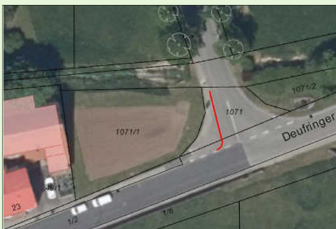
Versuch 2 (Eingrenzen der Fahrbahn mit Leitschwellen, Leitschwellen in rot dargestellt)
