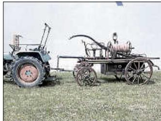
von der Konstruktionsform einer Hydrophore. Es gab die Hydrophore in verschiedenen Baugrößen, die von kleinen tragbaren Modellen bis zu großen von Pferden gezogenen Wagen reichte. Schon bei den kleinen Pumpen waren zur Bedienung vier Mann erforderlich.
